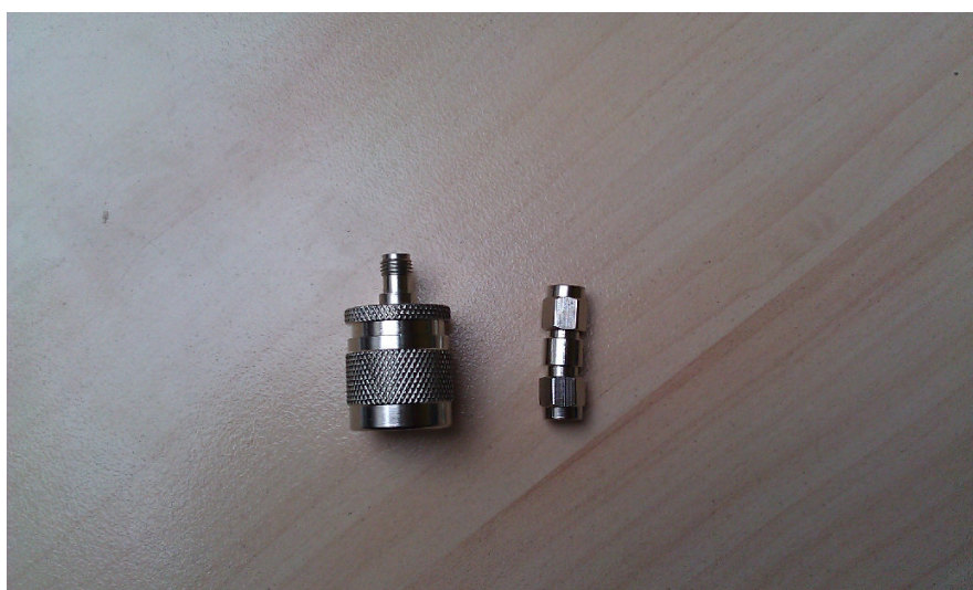
Redukce pro připojení měřeného portu na analyzátor.
