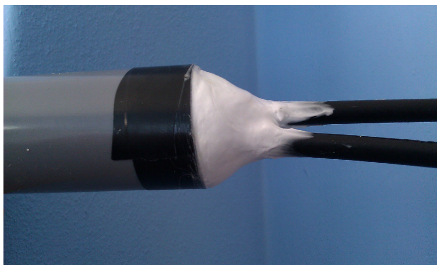
Montáž děliče do silnostěnné PVC trubky, utěsnění a upevnění neutrálním silikonem na koncích.
