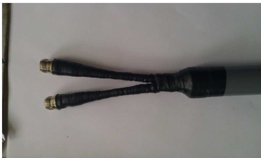
Konečné provedení, vyztužení, zatěsnění vulkanizační páskou a PVC páskou.
